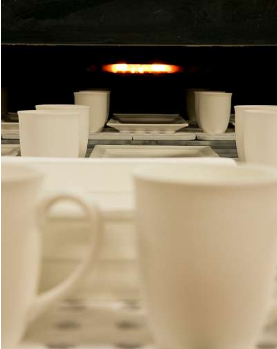
Tassen, Teller und Schalen laufen über ein Band in grosse Glasurbrandöfen.
